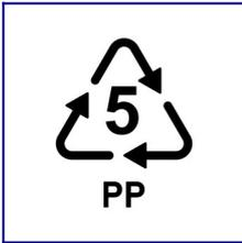
Il **PP**, o **Polipropilene**, è una plastica molto forte, ma anche flessibile. Inoltre è in grado di sopportare alte temperature fino a circa 200° C. Per queste sue proprietà è impiegata per quanto concerne vassoi per forni a microonde, cannucce, bollitori, componenti per auto e soprattutto per i vasetti di yogurt. Se la sua capacità di resistere al caldo la rende una plastica molto utile, d'altra parte proprio perché termoisolante risulta estremamente complicata da riciclare.
